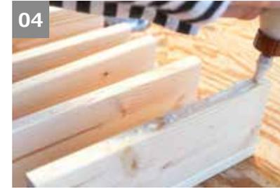
04 残りの**①**(9枚)を仮固定するために側面に木工用接着剤を塗る。
