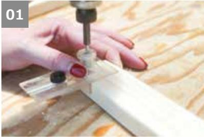
01 墨付け図を参考に、印を付け、**③****④****⑤**に2.5mmドリルで下穴を開ける。アングルには4mm鉄工用ドリルで下穴を開ける。
