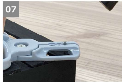
07 ⑥の接着剤が乾いたら、④の両端を1カ所ずつ小鋸で固定する。⑥の板厚が6mmなので、端から3mm部分に小鋸を打つ。 ※片面で16カ所になります。
