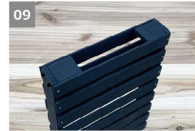
09 ①でカットした25mmの⑥を⑧の上面の両端に木工用接着剤で仮固定する。
