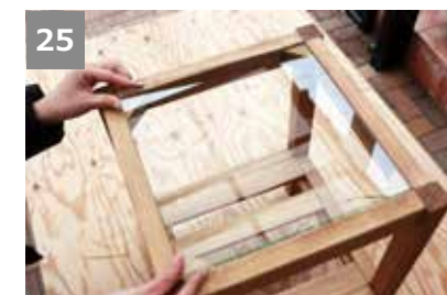
25 本体にアクリルを乗せる。 ※アクリルを固定する場合は、多用途接着剤または透明な強力両面テープなどを使用すると良い。
