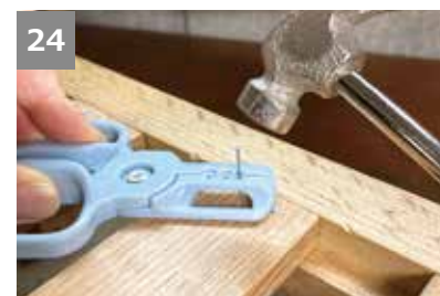
24 ⑲の両端を2か所ずつ小鋸で固定する。
