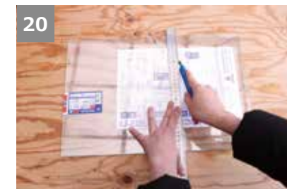
20 アクリルをアクリル用カッターでカットする。 ※アクリルのカット時は、作業台保護のため、下に端材を敷いて行う。
