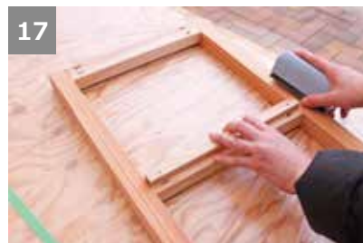
17 鉛筆部分を消しゴムで消し、すべての木材をサンドペーパーで磨く。
