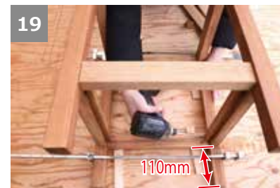
19 ⑯の間に、⑮(B')を上面と下から110mmの位置に合わせて、スリムビス45mmで固定する。 ※⑨同様、6mmの端材を敷いて⑮(A)と⑮(B')の高さを揃える。
