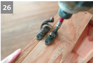
フタの前面に留め金を取り付ける。
