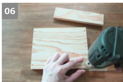
⑥と⑦1枚に2.5mmドリルで下穴をあける。 ※穴あけ位置は墨付け図参照
