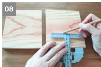
⑧の下から44mmと96mmの位置に印を付ける。 ※墨付け図参照
