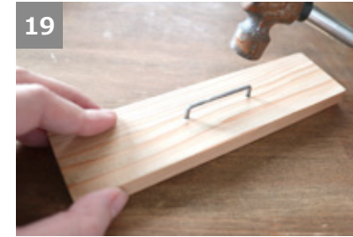
残りの③2枚の中心に、糸カスガイを金づちで打ち込む。
