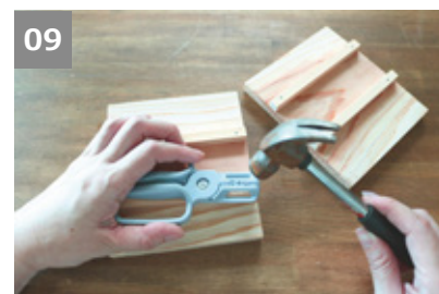
⑧で付けた印に合わせて、⑨を細釘19mmで2カ所ずつ固定する。
