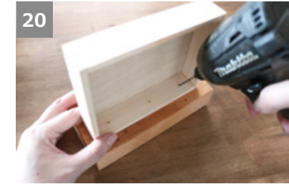
引き出しの前面内側から、2.5mmドリルで3カ所下穴をあける。
