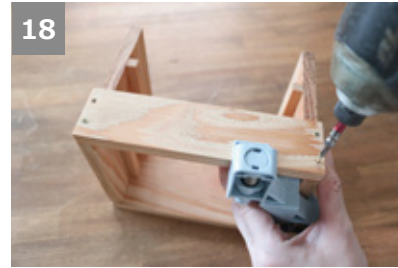
⑦の、⑥と反対側に、③を上面に合わせ、固定する。
