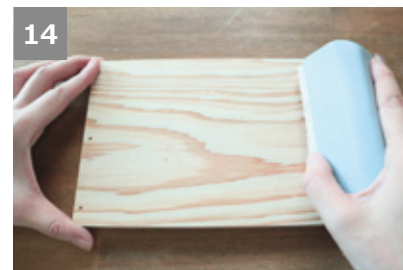
鉛筆部分を消しゴムで消し、すべての木材をサンドペーパーで磨く。
