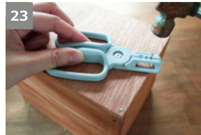
本体の底面に⑧を合わせ、細釘19mmで8カ所固定する。
