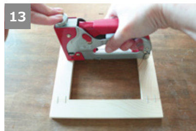
⑤で接着したフタ部は、裏面からタッカー(8mm)で木の境目を2カ所ずつ固定する。
