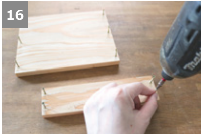
⑥と③の下穴に極細ビス25mmを仮留めする。 ※仮留めは、ビスを深く打ち込まず、ビスが自立する程度だけ打ち込む。
