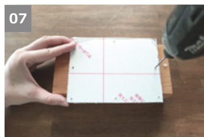
アクリル板の端から5～6mm内側に2.5mmドリルで8カ所貫通穴をあける。 ※貫通穴をあける場合は、下に端材を敷いて行う。
