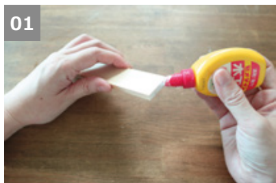
⑥の両端に木工用接着剤を塗る。
