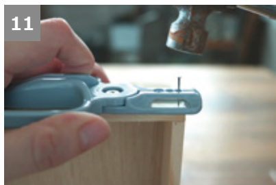
④で接着した引き出しを、⑦の両端から2カ所ずつ、細釘13mmで固定する。
