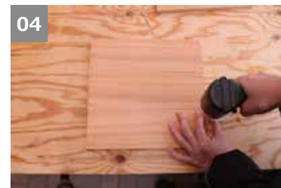
04 (A)(B)接ぎ板は、下から6mmの位置に3か所ずつ下穴を開ける。さらに、(B)接ぎ板は左右から6mmの位置に6か所ずつ下穴を開ける。※墨付け図参照
