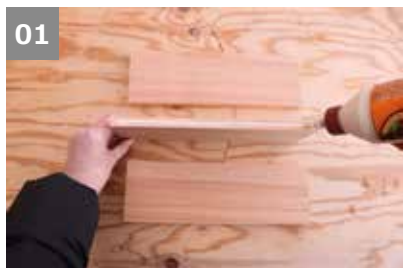
01 杉材(A)(B)1枚ずつの両側面に木工接着剤を塗る。
