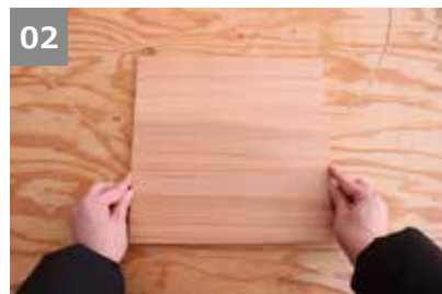
02 杉材(A)(B)ともに、①を両端から挟み、接ぎ合わせる。
