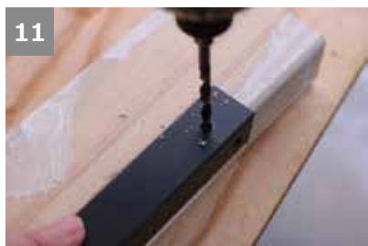
11 アングルの上下に2か所ずつ3mmドリルで貫通穴を開ける。その際、打ち込むビス通しが重ならないように、左右で貫通穴を開ける位置を少しずらす。※貫通穴を開ける際は、下に端材を敷いて行う。
