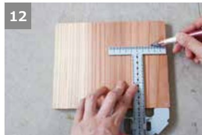
12 ⑩裏面の下から60mmと108mmの部分に線を引く。
