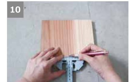
10 ⑨の両端と⑧の下から6mmの部分に、3か所ずつビスを打つ印を付ける。
