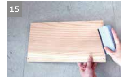
15 鉛筆部分を消しゴムで消し、すべての木材をサンドペーパーで磨く。
