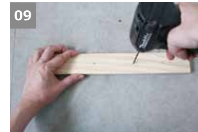
09 ⑧の印に、4~5mmドリルビットで貫通しない程度の下穴をあける。 ※市販のつまみを使用する場合も、ここで穴をあけておくと◎。ビス固定の場合は不要。
