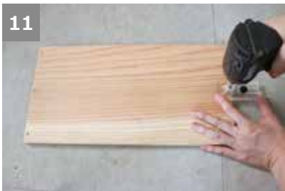
11 ⑩で付けた印に、2.5mmドリルビットで貫通しない程度の下穴をあける。
