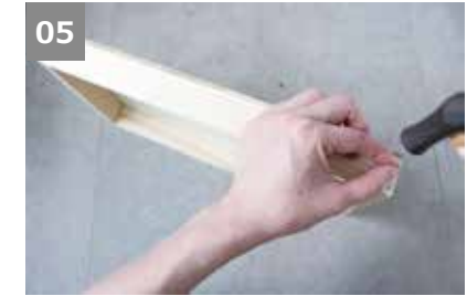
05 ④の接着剤が乾いたら、小鋸13mmで⑥の両端を2か所ずつ固定する。板厚が6mmなので端から3mm部分に打ちます。
