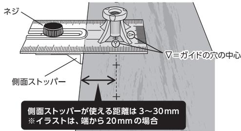
②ドリルガイドに付いている▽を穴位置に合わせます。側面ストッパーをスライドさせて、木材の端までの距離になるようにネジで固定します。
