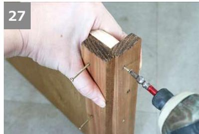
合板の側面(短辺側)に木工用接着剤を塗り、杉材◎を合わせて固定する。
