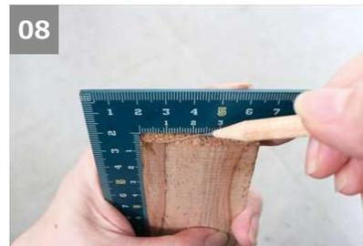
08 杉材④の1枚の片木端と片小口の底側に同角から22.5mmの部分に印をつける。
