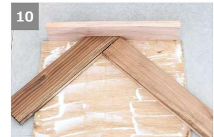
10 ⑧の杉材を45度に傾けて、2つの印を合板の線上に合わせ、かつ、直角を合板の上端に合わせる。左上の45度の隙間に④のカットした杉材を合わせる。**#3**
