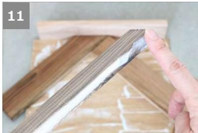
11 以後、貼り合わせ図を参考に残りの④も木端に木工用接着剤を塗りながら同様に貼り合わせて行き、下の方は杉材⑤・⑥を使いながら、合板が隠れるまで貼り合わせる。(貼り合わせ図-1)
