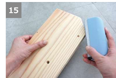
15 ④で引いた部分以外の鉛筆部分を消しゴムで消し、すべての木材をサンドペーパーで磨く。
