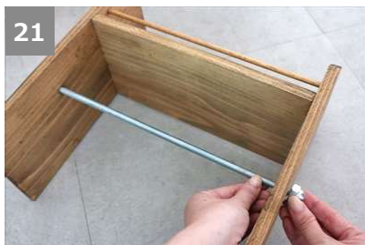
21 9mmドリルビットであけた穴にナガネジを通し、外側から袋ナットをかぶせる。
