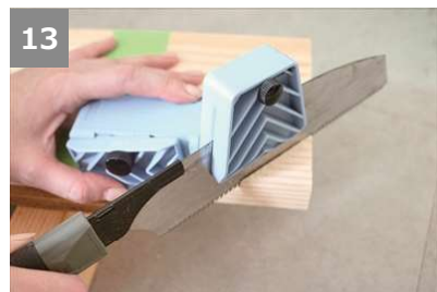
13 杉材◎2枚を重ねて養生テープで固定し、斜め45度に引いた線の部分をのこぎりでカットする。
