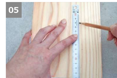
05 背側から45mm、下から120mmの部分にナガネジを通す穴の印をつける。 #1
