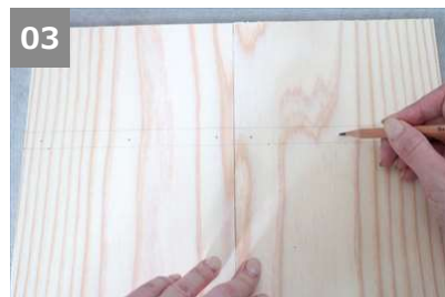
03 線と線の間均等に3か所ずつビスを打つ印をつける。
