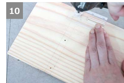
10 ③と⑨でつけた印に2.5mmドリルビットで深さ7mmほどの下穴をあける。 #2
